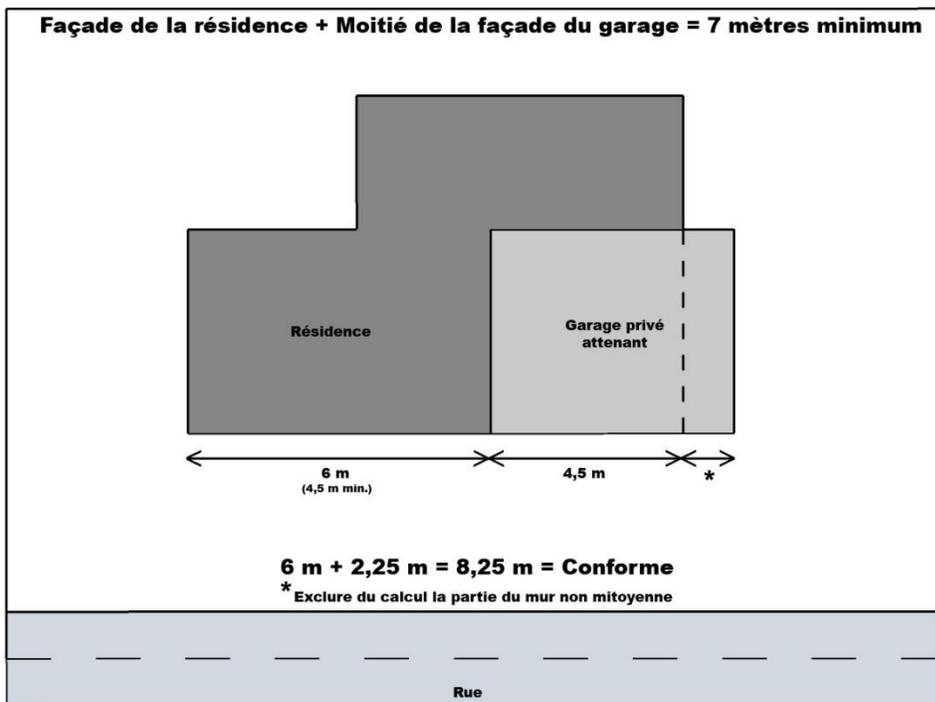
Schéma 4.3 – Calcul de la façade principale d'un bâtiment principal (situation au point B)
